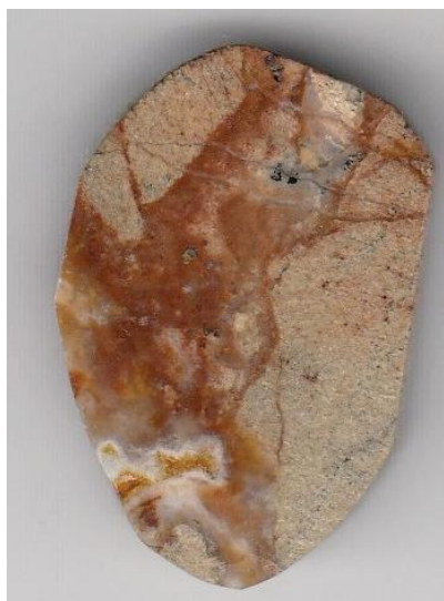
Рис. 5. Прожилок тонкозернистого пропитанного гидроксидами железа жильного кварца в аплитовидном граните. Образец 303/7. Размер 2,5 x 4 см / Fig. 5. Vein of fine-grained vein quartz impregnated with iron hydroxides in aplite-like granite. Sample 303/7. Size 2,5 x 4 cm
