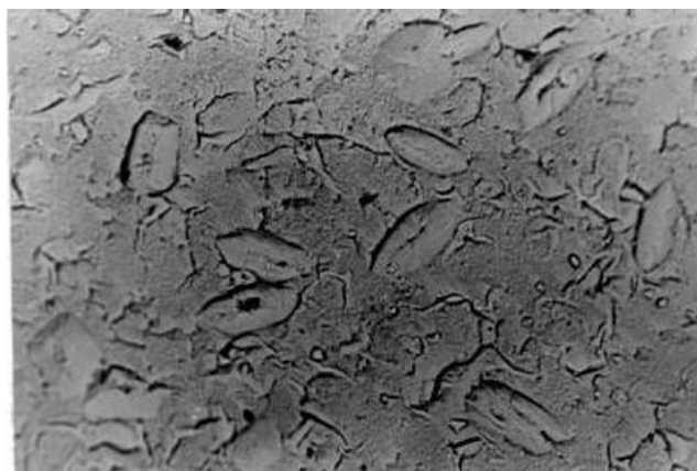
Рис. 9. Типичные выделения микровключений петцита в пирите. Угльно-целлюлозная реплика. Ув. 7000. Снято В. Н. Аношкиным. Лаборатория минералогии ЗабКНИИ Мингео СССР / Fig. 9. Typical segregations of petcite microinclusions in pyrite. Carbon-cellulose replica. Increased 7000. Photographed by V.N. Anoshkin. Mineralogy Laboratory of the ZabKNII Mingeo USSR
