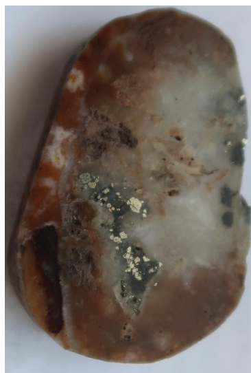
Рис. 6. Включения пирита с петцитом в обломке ранней рудной ассоциации. Образец 322/7. Размер 2,8 x 3,8 см / Fig. 6. Inclusions of pyrite with petzite in the fragment of the early ore association. Sample 322/7. Size 2.8 x 3.8 cm
