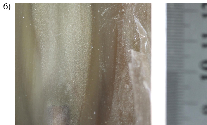
Рис. 4. Структура канала плюма при N = 6,4 Вт, Ka = 1,18 : а – канал плюма длиной H = 287 мм (относительной длиной 25); б – фотография картины течения над нагревателем / Fig. 4. The structure of the plume conduit for N = 6.4 W, Ka = 1.18 ; а – the plume conduit with a length of H = 287 mm (relative length 25); б – the flow pattern above the heater
