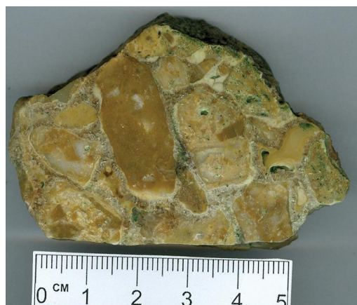
Рис. 4. Фрагмент брекчии с флюорит-кварцевым цементом. Образец 233_7. / Fig. 4. Fragment of a breccia with fluorite-quartz cement. Sample 233_7.
